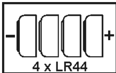
Rys. 5.1. Prawidłowe umieszczenie baterii
